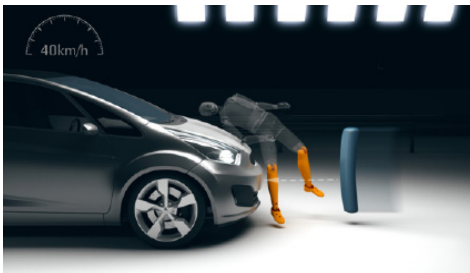
شکل ۳۲. شماتیک آزمایش ضربه به قسمت‌های تحتانی پا
