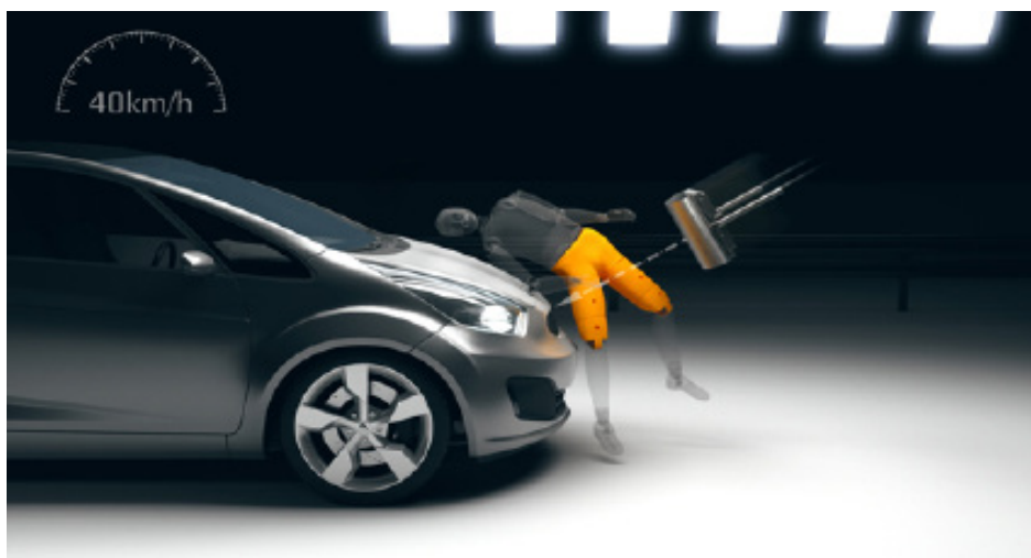
شکل ۳۱. شماتیک آزمایش ضربه به قسمت‌های فوقانی پا
