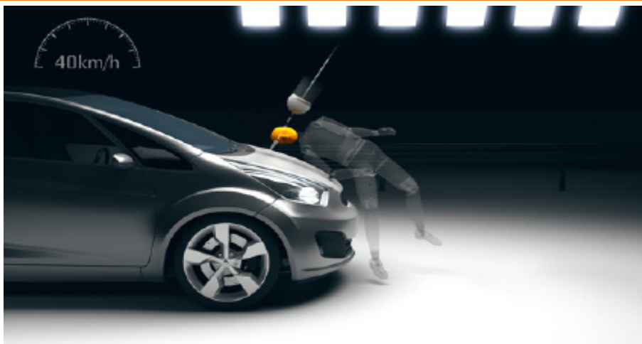
شکل ۳۰. شماتیک آزمایش ضربه به سر
