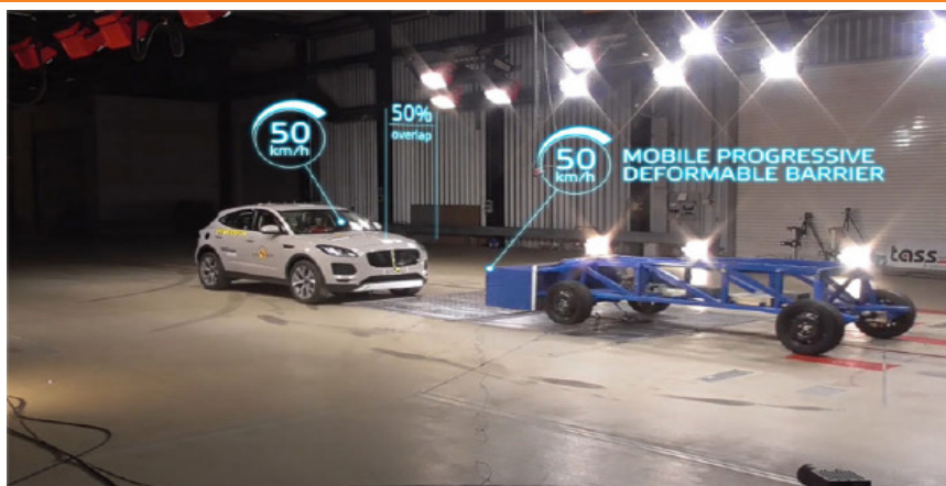
شکل ۱۶. شماتیک آزمایش برخورد از جلو با یک مانع متحرک
