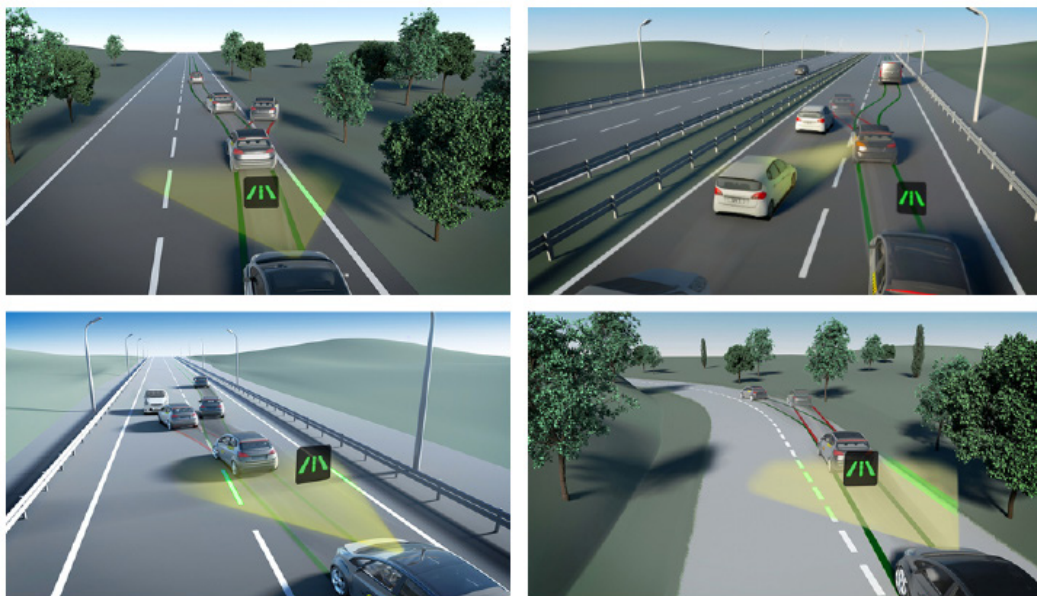
شکل ۴۵. بررسی عملکرد سیستم‌های کمکی برای حفظ مسیر حرکت خودرو در حالت‌های مختلف
