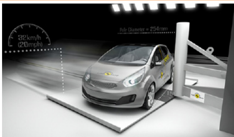
شکل ۲۰. شماتیک آزمایش برخورد جانبی با تیر
