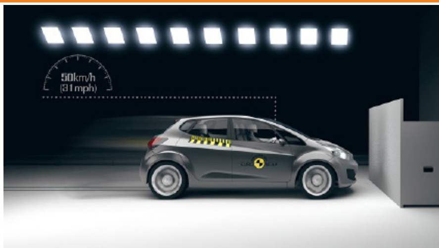
شکل ۱۷. شماتیک آزمایش برخورد از جلو با یک مانع ثابت
