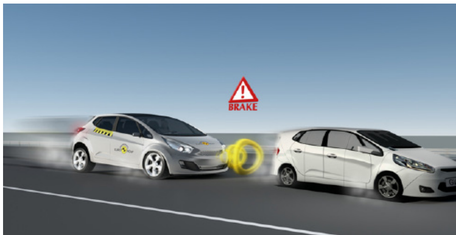
شکل ۳۸. شماتیک آزمایش ارزیابی ترمز اضطراری خودکار برای خودرو
