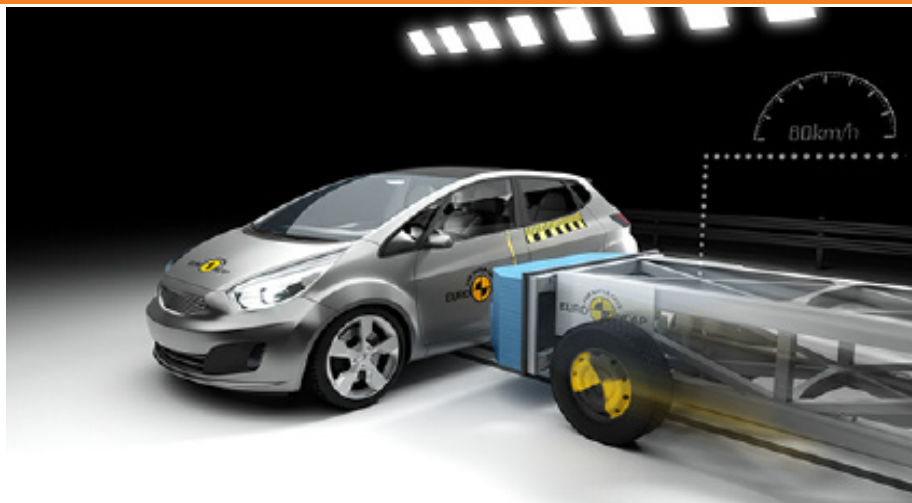
شکل ۱۹. شماتیک آزمایش برخورد جانبی با جسم متحرک
