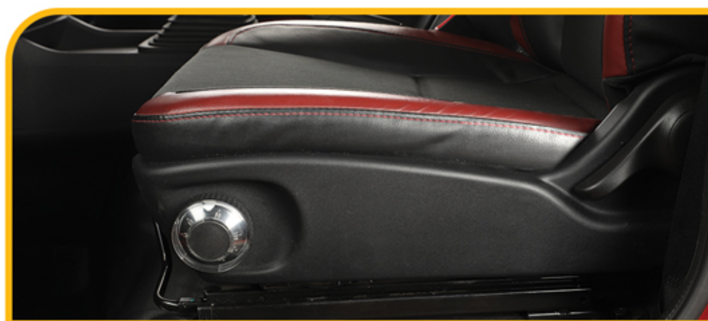
صندلی راننده با تعلیق مکانیکی و قابلیت تنظیم در ۴ جهت
