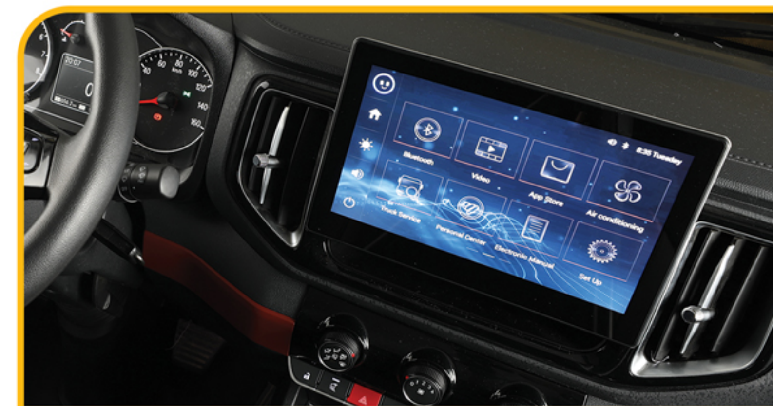
سیستم مولتی مدیا TFT لمسی (رادیو، رهیاب، بلوتوث، SD، USB)
